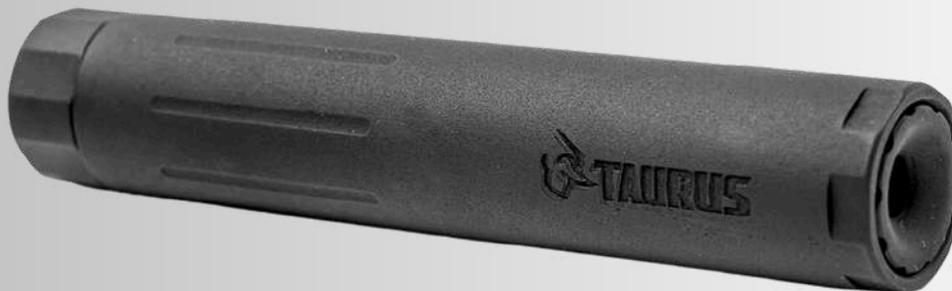
O SUPRESSOR ST 22 PISTOLA é ideal para quem busca uma opção de equipamento para calibre específico, tendo alto desempenho e peso reduzido de 125 g. Contando com sistema de conexão por rosca direta na especificação de 1/2" – 28. Utilizado no calibre .22, reduzindo em até 25 dB o ruído dos disparos. Produzido totalmente em alumínio aeronáutico com acabamento anodizado ou exclusivo em Cerakote® Graphene na cor preta.
